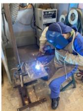
手溶接、半自動溶接による溶接作業に関する技能を習得します。
